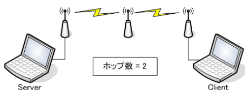
図 4 カスケード接続タイプ：ホップ数が2のときの実験概略図
